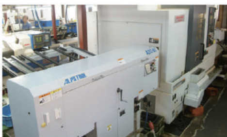
森精機／NL2000SY／ \phi 62 までの連続複合加工機
