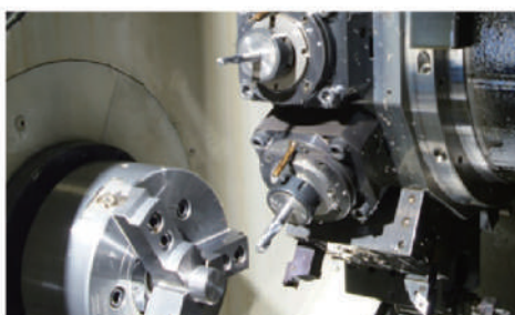
森精機／NL2000SY／ \phi 62 までの連続複合加工機
