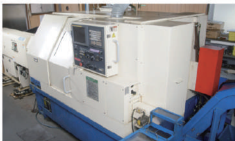
ツガミ／M50SY／ \phi 50 までの複合加工機
